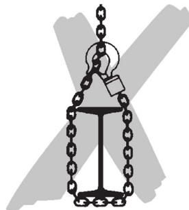
Lastkette nicht knoten oder mit Bolzen, Schraube, Schraubendreher oder ähnlichem verkürzen. Fest in Hebezeuge eingebaute Lastketten dürfen nicht instandgesetzt werden.
